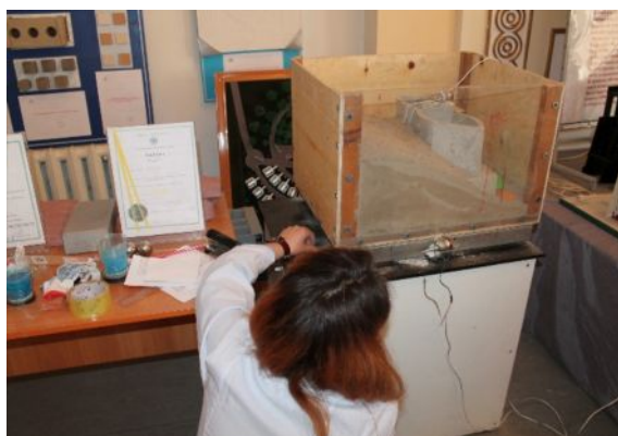
Рис.П.1.3. Испытание модели полурадиальной стенки
