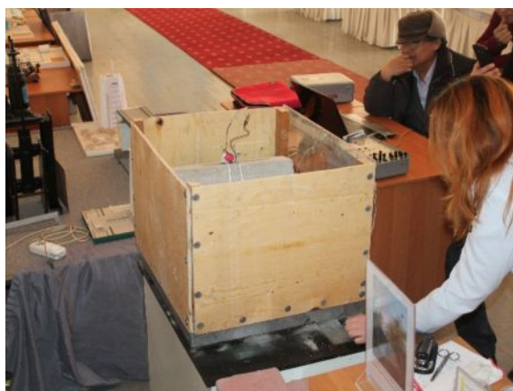
Рис.П.1.1. Испытание модели гравитационной стенки
