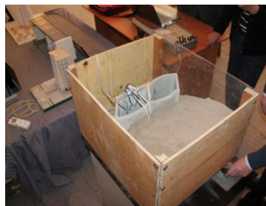
Рис.П.1.4. Измерения показаний модели полурадиальной стенки
