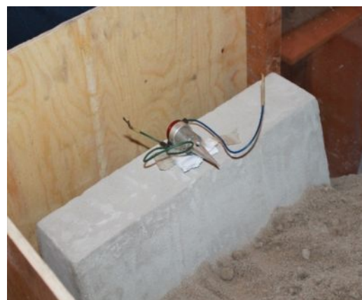
Рис.П.1.2. Измерения показаний модели гравитационной стенки
