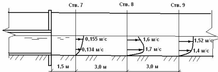
Рис. 9. Вертикальные эпюры скоростей по оси отводящего канала Бочкаревский
