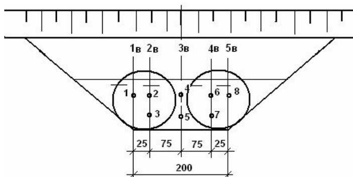
Рис. 6. Схема расположения точек замера скоростей в канале Бочкаревский
