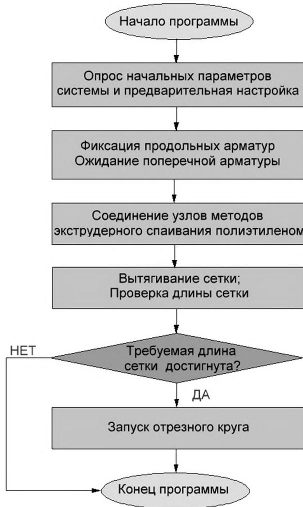
Рисунок 3 — Алгоритм управляющей программы
