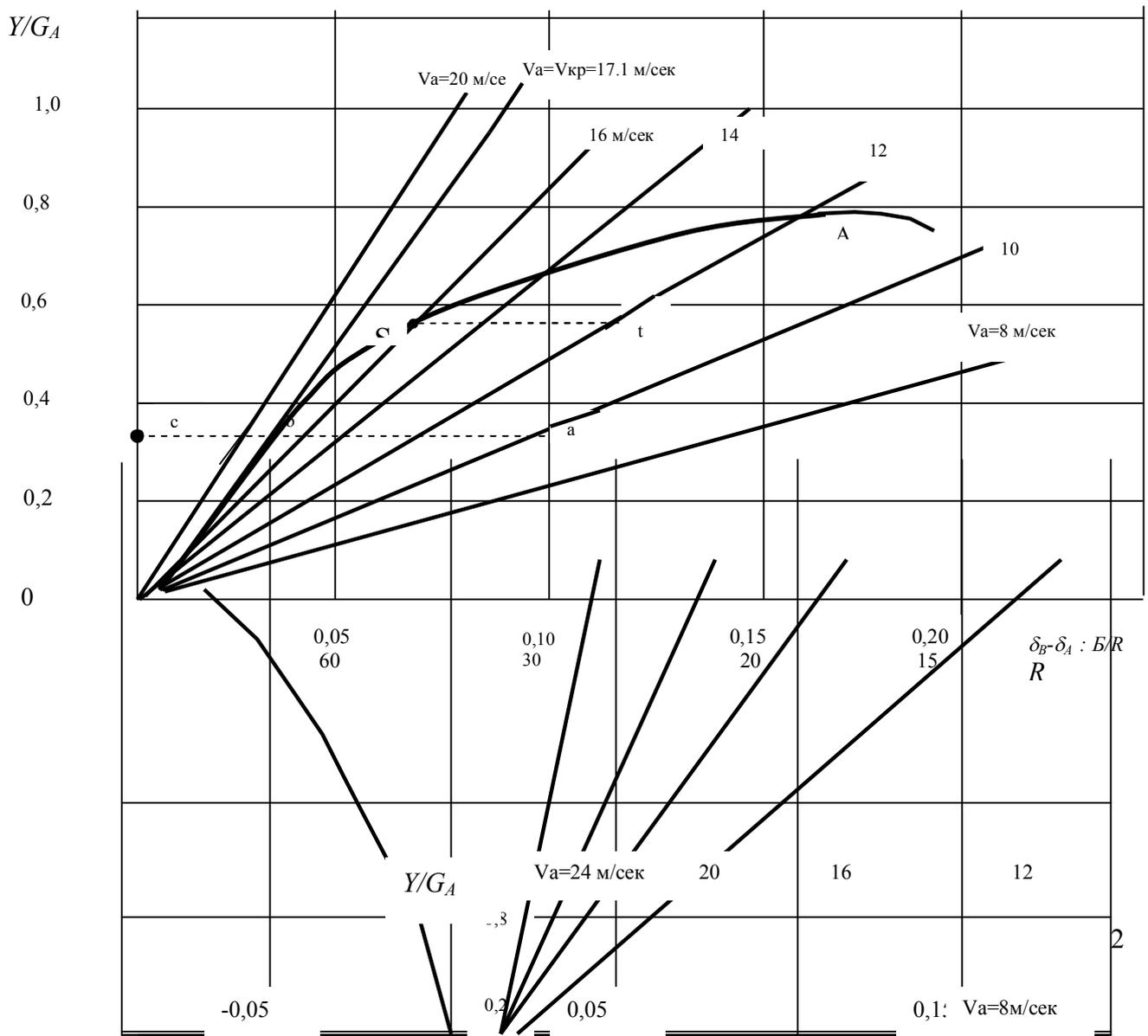
Рис.1. Диаграмма устойчивости автомобиля с излишней поворачиваемостью
