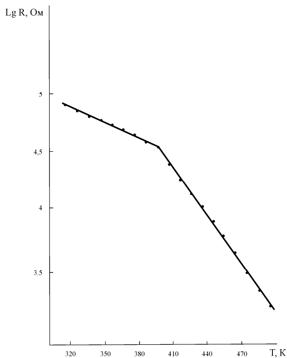
Рис. 3. Зависимость сопротивления от температуры для феррита стронция \text{YbSrFe}_2\text{O}_{5,5}
