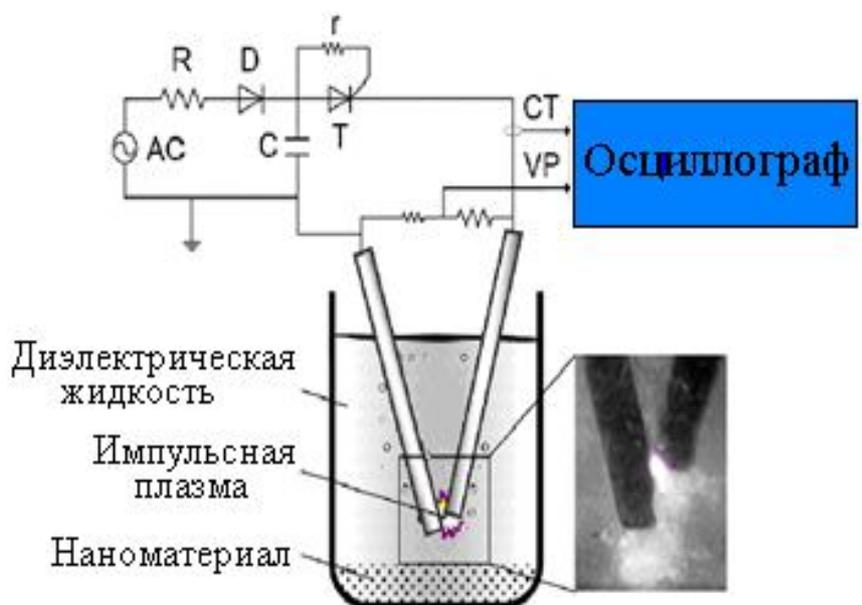
Рис. 2.1. Технологическая схема наноструктурирования металлов в импульсной плазме, создаваемой в жидкостях.
