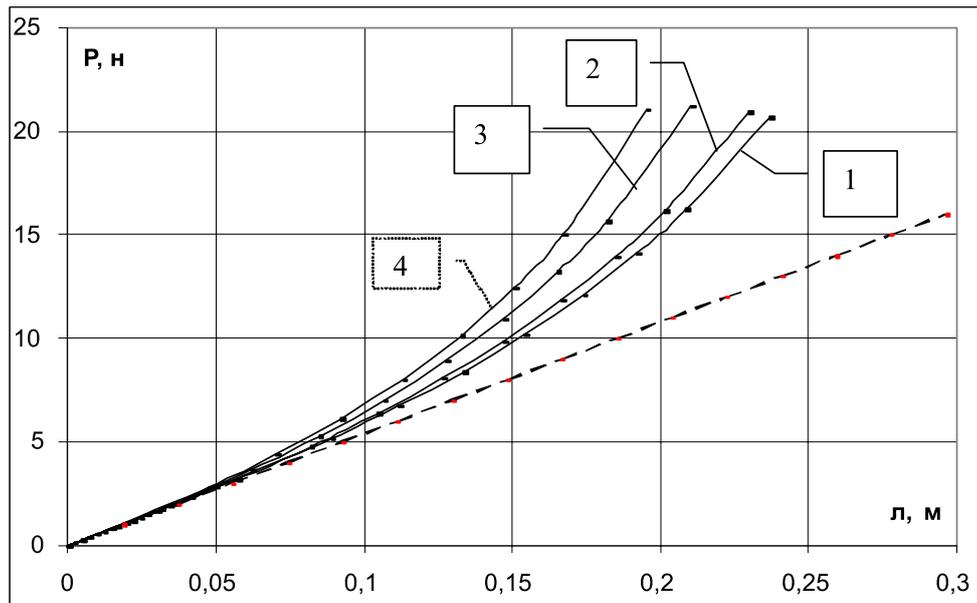
Рис. 2. Зависимость  $P$  от  $\lambda$ . Пунктирная линия соответствует расчету по линейной теории для  $\alpha_0=1,54^\circ$ .
