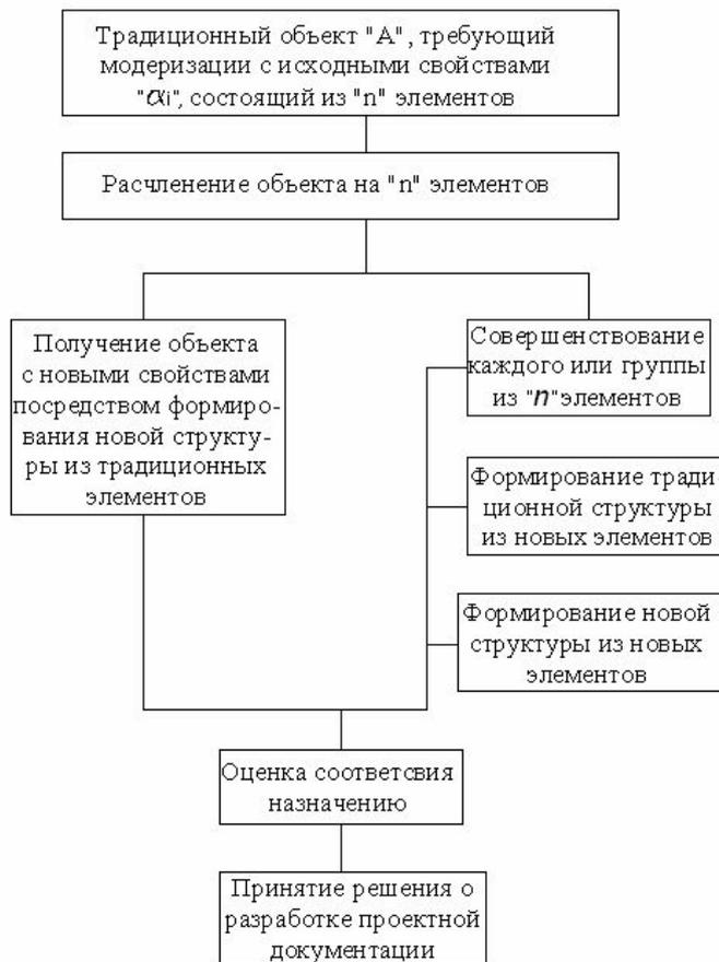
Рис. 1. Схема формирования нового конструктивного решения методом расчленения
