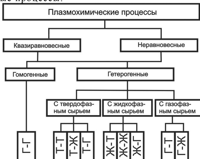
Рис. 1. Классификация плазмохимических процессов
