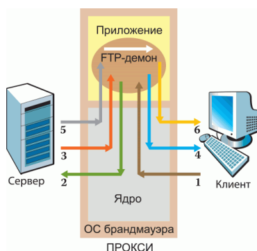
Рис. 2. Межсетевые экраны-посредники устанавливают сессию с хостом-источником, а потом от его имени – сессию к хосту назначения
